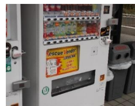
災害対応型自動販売機の設置
